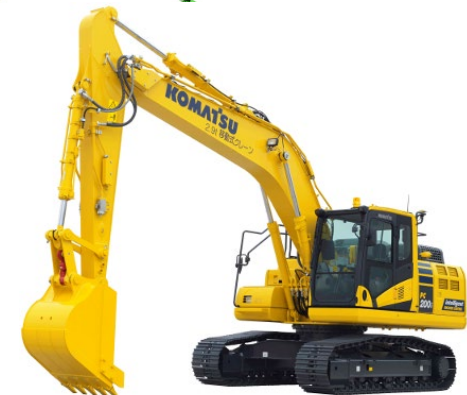
コマツICT油圧ショベル
